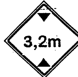
A-37 Altura Limitada
